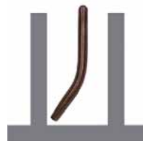
Применение изогнутой контактной трубки
